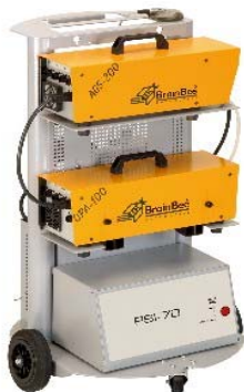
stojan TRO 050, měřící komory a zdroj PSI - 70
